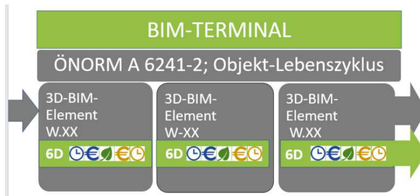
Abbildung 1: Im BIM-Terminal werden die 3D-Informationen aus den CAD-Programmen eingelesen, um 6D-Informationen ergänzt (4D: Zeit, 5D: Errichtungskosten, 6D: LCA/LCC; blaue ICONs: Errichtung; braune: Nutzung). FachkonsulentInnen können die für sie erforderlichen Daten gefiltert aus dem BIM Terminal auslesen.
